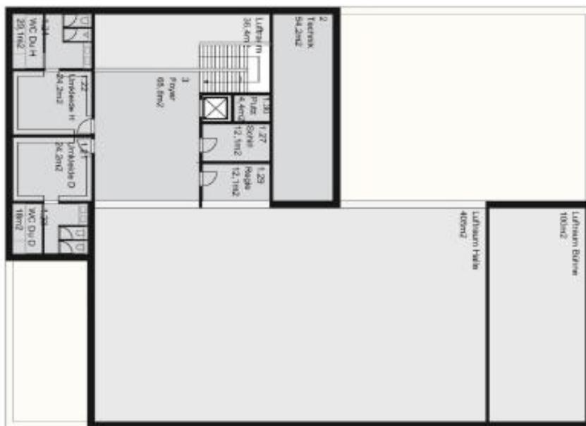
Abbildung 6 Mögliche Anordnung der Räume in einer 2-geschossigen Halle, OG
