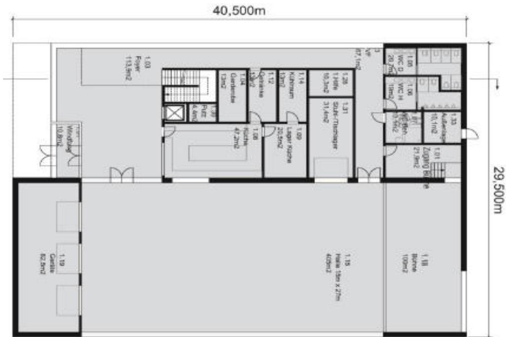
Abbildung 5 Mögliche Anordnung der Räume in einer 2-geschossigen Halle, EG
