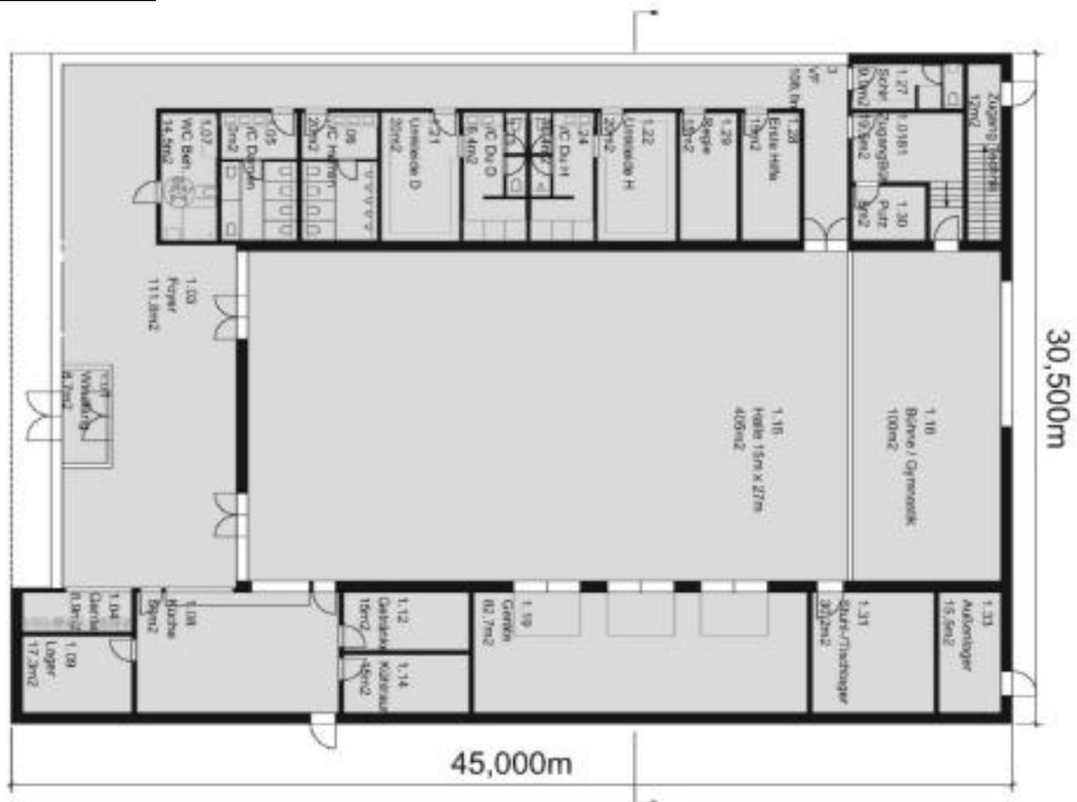
Abbildung 1 Mögliche Anordnung der Räume in einer eingeschossigen Halle
